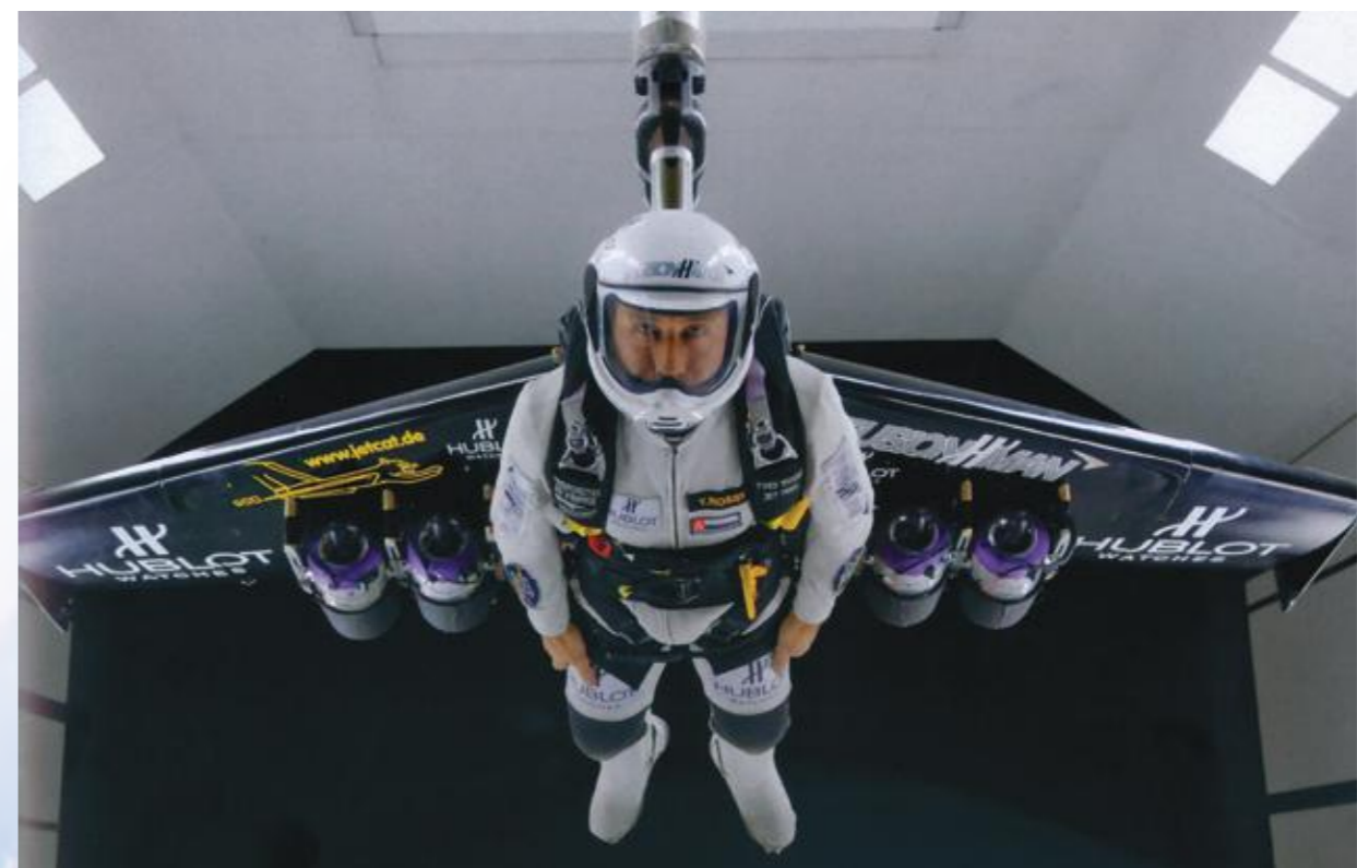
A fim de obter uma base de dados inexistente até então, Yves Rossy testou a sua asa num túnel de vento.
